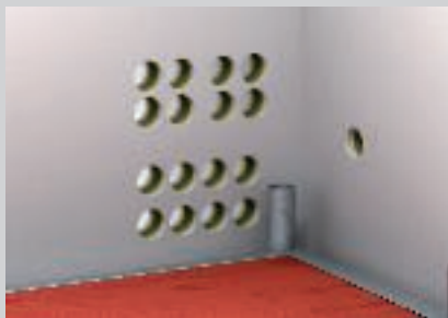
Groepsgewijze opstelling van de boringen.
