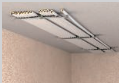
Eenvoudige kabelinstallatie door via de zijkant plaatsen van de kabels.
