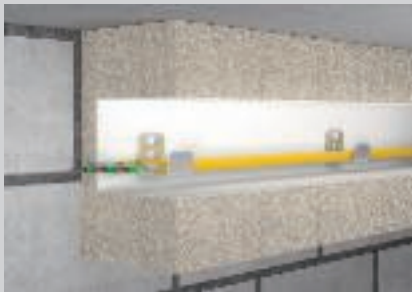
Bevestigingshoek als montagehulp voor het installeren van de optische kabels (LWL).
