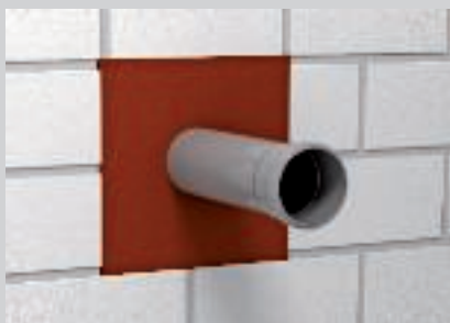
Brandbare buizen tot Ø 50 mm doorvoerbaar zonder aanvullende maatregelen.
