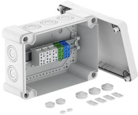
Boîtier de dérivation pour le raccordement des câbles et conduits en intérieur et en extérieur. Forme rectangulaire avec entrées défonçables. Convient pour le montage mural/au plafond avec possibilité de fixation intérieure, extérieure ou de montage sur les dômes angulaires. Particulièrement résistant aux chocs avec IK08. Couvercle avec fermeture rapide, plombable. Fabriqué à partir de matériaux sans halogène et résistants aux UV.
