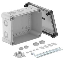
Boîte de dérivation avec rail DIN profilé pour connecter des câbles et des conduites en intérieur et en extérieur.. Forme rectangulaire avec entrées défonçables. Convient pour le montage au mur / au plafond avec possibilité de fixation extérieure, de fixation intérieure ou de montage sur les dômes d'angle. Particulièrement résistant aux chocs avec IK09 Couvercle transparent avec fermeture rapide, plombable. Fabriqué à partir de matériaux sans halogène et résistant aux UV.
