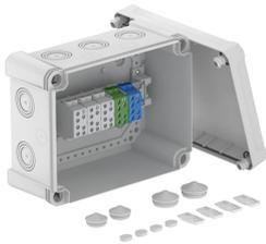
Boîtier de dérivation pour le raccordement des câbles et conduits en intérieur et en extérieur. Forme rectangulaire avec entrées défonçables. Convient pour le montage mural/au plafond avec possibilité de fixation intérieure, extérieure ou de montage sur les dômes angulaires. Particulièrement résistant aux chocs avec IK09. Couvercle avec fermeture rapide, plombable. Fabriqué à partir de matériaux sans halogène et résistants aux UV.
