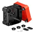
Boîtier de dérivation pour le raccordement de câbles et conduits en intérieur et en extérieurs protégés. Forme carrée avec entrées défonçables. Convient pour le montage au mur / au plafond avec possibilité de fixation extérieure, de fixation intérieure ou de montage sur les dômes d'angle. Particulièrement résistant aux chocs avec IK09. Couvercle avec fermeture rapide, plombable. Fabriqué à partir de matériaux sans halogène et résistant aux UV.
