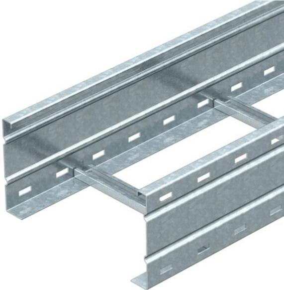
Échelle de câbles longue portée avec longeron latéral perforé d'une hauteur latérale de 160 mm. Fixation de câbles et conduits avec bride de fixation de type 2056.
