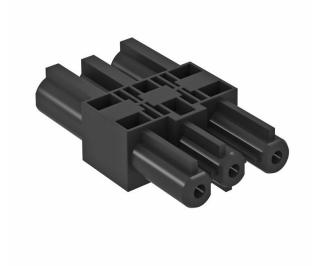
Adaptateur de raccordement GST18i pour réunir des prises de courant STD-D0C / STD-D3C ou STD-F0C / STD-F3C en association avec des adaptateurs de raccordement droits, raccord enfichable avec décharge de traction intégrée. Adapté pour le raccordement d'appareils dans le système de canal de montage d'appareillage Rapid 45 et Rapid 80 et de colonnes de distribution ISS.
