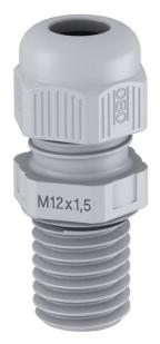
Presse-étoupe avec raccord fileté métrique de type écrou borgne, pour boîtes de dérivation, boîte, coffrets de distribution dans le domaine privé et industriel. Avec décharge de traction et lèvre d'étanchéité intégrée, testé selon la norme DIN EN 62444. Indice de protection IP68. Utilisation possible de -20 °C à +65 °C
