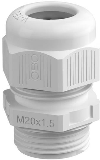
Presse-étoupe avec raccord fileté métrique de type écrou borgne, pour boîtes de dérivation, boîte, coffrets de distribution dans le domaine privé et industriel. Avec décharge de traction et lèvre d'étanchéité intégrée, testé selon la norme DIN EN 62444. Indice de protection IP68. Utilisation possible de -20 °C à +65 °C
