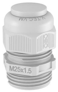
Presse-étoupe avec raccord fileté métrique de type écrou borgne, pour boîtes de dérivation, boîte, coffrets de distribution dans le domaine privé et industriel. Avec décharge de traction et lèvre d'étanchéité intégrée, testé selon la norme DIN EN 62444. Indice de protection IP68. Utilisation possible de -20 °C à +65 °C Cela permet de fermer sans difficulté des ouvertures non utilisées. La poussière ou l'eau ne pouvant pénétrer, l'indice de protection est maintenu.
