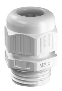
Presse-étoupe avec raccord fileté métrique de type écrou borgne, pour boîtes de dérivation, boîte, coffrets de distribution dans le domaine privé et industriel. Avec décharge de traction et lèvre d'étanchéité intégrée, testé selon la norme DIN EN 62444. Indice de protection IP68. Utilisation possible de -20 °C à +65 °C
