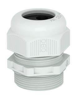
Presse-étoupe avec raccord fileté métrique de type écrou borgne, pour boîtes de dérivation, boîte, coffrets de distribution dans le domaine privé et industriel. Avec décharge de traction et lèvre d'étanchéité intégrée, testé selon la norme DIN EN 62444. Indice de protection IP68. Utilisation possible de -20 °C à +65 °C
