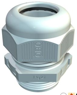
Presse-étoupe avec raccord fileté PF de type écrou borgne, pour boîtes de dérivation, boîte, coffret de distribution dans le domaine privé et industriel. Avec décharge de traction et lèvre d'étanchéité intégrée, testé selon la norme DIN EN 62444. Indice de protection IP68. Utilisation possible de -20 °C à +65 °C
