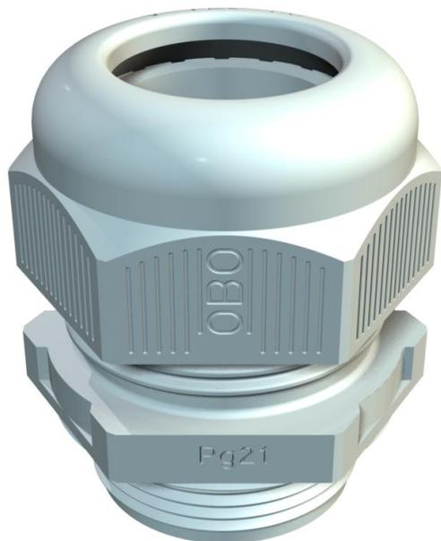
Presse-étoupe avec raccord fileté PF de type écrou borgne, pour boîtes de dérivation, boîte, coffret de distribution dans le domaine privé et industriel. Avec décharge de traction et lèvres d'étanchéité intégrée, testé selon la norme DIN EN 62444. Indice de protection IP68. Utilisation possible de -20 °C à +65 °C
