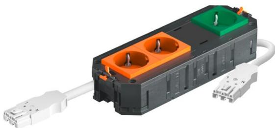
Le support universel prêt à raccorder UTC4 dispose de 2 prises à contact de protection à 33° préinstallées de couleur orange et d'une prise à contact de protection à 33° préinstallée en vert menthe, et d'un obturateur pour le montage ultérieur d'un dispositif d'installation de la série Modul45 ou Modul 45connect 250 V~ 16 A.
