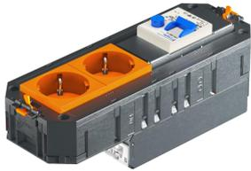
Support universel prêt à raccorder Connect UTC4 avec système de connecteur WAGO WINSTA® MIDI. Convient pour les câbles de raccordement VL-WIN et pour l'utilisation dans les unités d'appareillage de taille nominale R7, 9 et R9. Le support universel prêt à raccorder UTC4 FI dispose de 2 prises à contact de protection, sécurisées avec interrupteur différentiel. Câblage interne avec 2,5 mm<sup>2</sup>. Veuillez observer les conditions de raccordement (ainsi que la sélectivité !)
