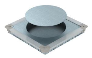
Boîte d'appareillage sous plancher avec couvercle de montage et plaque borgne, avec parois latérales en tôle d'acier. Pour le montage d'un boîtier de sol carré GES9 55 dans des hauteurs de chape à partir de 55 mm. Possibilité de nivellement continu à hauteur de la chape et la chape peut être coulée de manière affleurante à l'arête de retraite de la chape. Avec ouvertures d'entrée de tubes sur chaque côté 7 x M20, 3 x M25, 4 x M32. Taille de tubes utile pour la hauteur système de 55 mm : M20.
