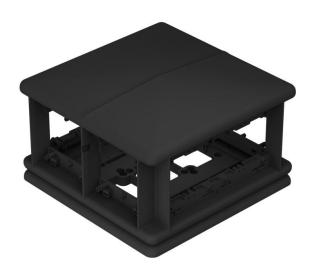
Unité d'appareillages saillante pour le montage de 8 appareillages simples à griffe ou à vis sur 4 côtés. La séparation des natures de courant (4 + 4) est assurée par une cloison de séparation. En cas d'utilisation d'appareillages multiples, la capacité de raccordement peut être augmentée. Modes de fixation par vis pour appareillages : 60 mm à la verticale.
