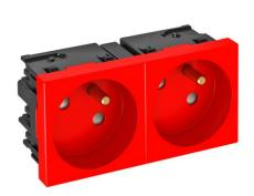
Prise de courant avec fiche de terre à raccordement latéral double 33°, avec protection renforcée contre les contacts accidentels, avec bornes à fiche, 2 pôles, , 16 A, 250 V~, avec bornes de raccordement selon CEI 60884-1.
