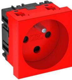
Prise avec fiche de terre, simple, version codée, avec protection accrue contre les contacts, avec bornes enfichables, 2 pôles, 16 A, 250 V ~, avec bornes de raccordement selon CEI 60884-1.
