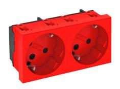
Prise de courant à contact de protection double 33°, version codée, avec protection renforcée contre les contacts accidentels, avec bornes à fiche, 2 pôles, 16 A, 250  $V\sim$ , avec bornes de raccordement selon CEI 60884-1.
