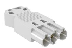
Fiche mâle à 3 pôles, type GST18i avec raccord à vis, hauteur de montage faible (aucune perte d'emplacement en combinaison avec des blocs de distribution), pour une section de 0,75 à 2,5 mm², un conducteur fin pouvant être raccordé sans douille d'extrémité, pour diamètre de câble de 6,5 à 10,5 mm (H05VV, NYM), non monté avec décharge de traction, possibilité de confection sur place, 250 V, 16 A.
