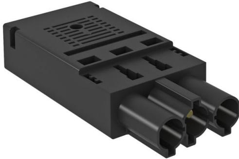
Partie mâle à 3 pôles, type GST18i avec raccord à ressort pour câble rigide de 1,5 à 2,5 mm<sup>2</sup>, unifilaire ou soudé par ultrasons, câbles fins 1,5 mm<sup>2</sup> avec douilles d'extrémité, non montée avec décharge de traction, possibilité de confection sur place, 250 V, 16 A.
