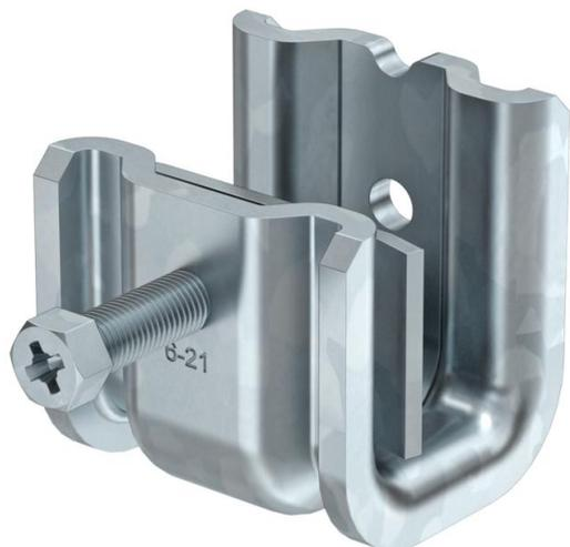
Ce type de pince de fixation est poussé sur le support et fixé sur le support ou un fer plat au moyen d'un patin de pression et d'une vis (M8). La vis hexagonale est dotée d'une ouverture de clé 10 mm. Il y a également deux filets M8 supplémentaires dans le corps de serrage, par exemple pour fixer des tiges filetées.
