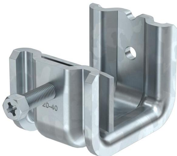
Ce type de pince de fixation est poussé sur le support et fixé sur le support ou un fer plat au moyen d'un patin de pression et d'une vis (M8). La vis hexagonale est dotée d'une ouverture de clé 10 mm. Il y a également deux filets M8 supplémentaires dans le corps de serrage, par exemple pour fixer des tiges filetées.
