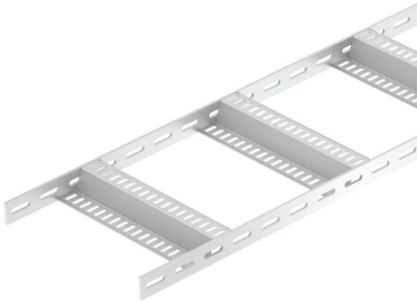
Échelle à câbles dédiée à la construction navale avec longeron latéral perforé d'une hauteur latérale de 40 mm, avec échelons en Z soudés et perforés. L'échelle à câbles en milieu naval, pièces de forme incluses, est également disponible sur demande en acier inoxydable. Revêtement par poudrage aux couleurs RAL possible.
