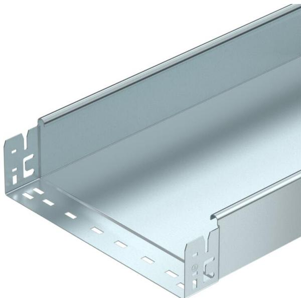
Chemin de câbles non perforé avec système de fixation rapide intégré La longueur utile des chemins de câbles est de 3 000 mm. La liaison équipotentielle constante est garantie sans élément supplémentaire.
