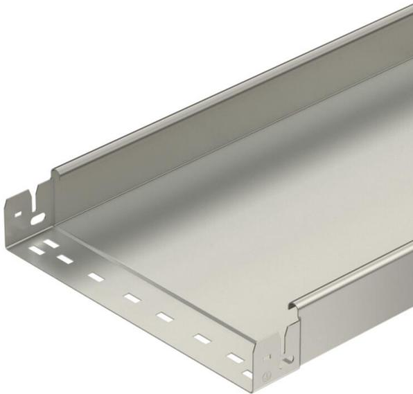
Chemin de câbles non perforé avec système de fixation rapide intégré La longueur utile des chemins de câbles est de 3 000 mm. La liaison équipotentielle constante est garantie sans éléments supplémentaires.
