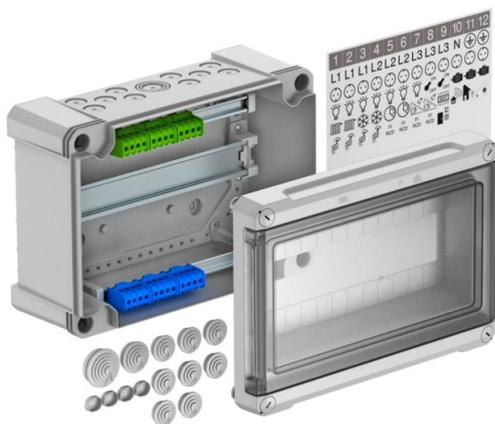
Petit distributeur avec bornier de raccordement pour montage apparent, pour la distribution secondaire en intérieur ou dans une zone extérieure protégée, selon la norme CEI 439-3. Avec rail DIN profilé prémonté de 35 mm. Indices de protection IP66 et IK06. Couvercle transparent à visser, avec découpe.
