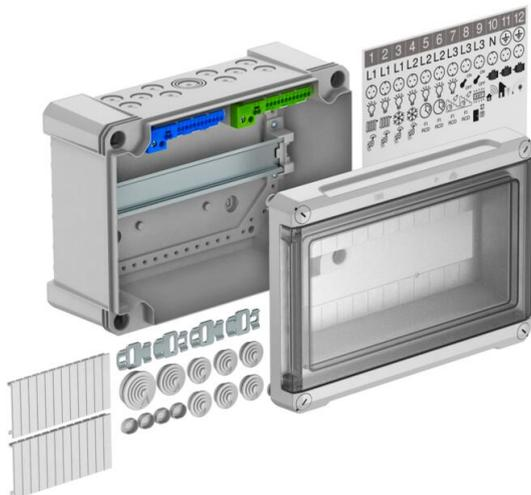
Petit distributeur avec bornier de raccordement pour montage apparent, pour la distribution secondaire en intérieur ou extérieur, selon la norme CEI 439-3. Avec rail DIN profilé prémonté de 35 mm. Indices de protection IP66 et IK06. Couvercle transparent à visser, avec découpe.
