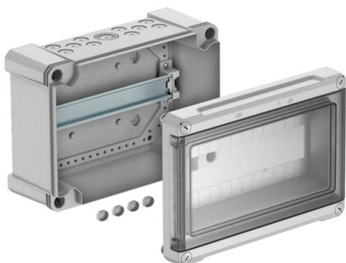
Distributeur avec bornier de raccordement pour montage apparent, pour la distribution secondaire en intérieur ou dans une zone extérieure protégée, selon la norme CEI 439-3. Avec rail DIN profilé prémonté de 35 mm. Indices de protection IP66 et IK06. Couvercle transparent à visser, avec découpe.
