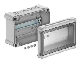
Distributeur avec bornier de raccordement pour montage apparent, pour la distribution secondaire en intérieur ou extérieur, selon la norme CEI 439-3. Avec rail DIN profilé prémonté de 35 mm. Indices de protection IP66 et IK06. Couvercle transparent à visser, avec découpe. 4 bouchons d'obturation de vis inclus.
