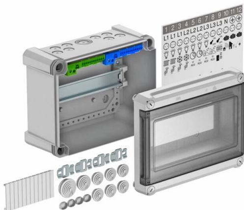
Petit distributeur avec bornier de raccordement pour montage apparent, pour la distribution secondaire en intérieur ou extérieur, selon la norme CEI 439-3. Avec rail DIN profilé prémonté de 35 mm. Indices de protection IP66 et IK06. Couvercle transparent à visser, avec découpe.
