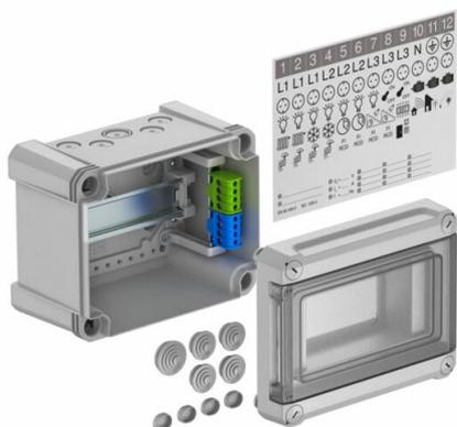
Petit distributeur avec bornier de raccordement pour montage apparent, pour la distribution secondaire en intérieur ou dans une zone extérieure protégée, selon la norme CEI 439-3. Avec rail DIN profilé prémonté de 35 mm. Indices de protection IP66 et IK06. Couvercle transparent à visser, avec découpe.
