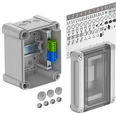
Petit distributeur avec bornier de raccordement pour montage apparent, pour la distribution secondaire en intérieur ou dans une zone extérieure protégée, selon la norme CEI 439-3. Avec rail DIN profilé prémonté de 35 mm. Indices de protection IP66 et IK06. Couvercle transparent à visser, avec découpe.
