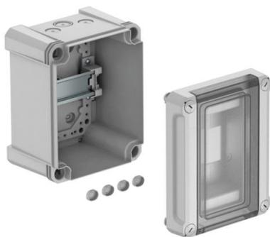
Distributeur avec bornier de raccordement pour montage apparent, pour la distribution secondaire en intérieur ou extérieur, selon la norme CEI 439-3. Avec rail DIN profilé prémonté de 35 mm. Indices de protection IP66 et IK06. Couvercle transparent à visser, avec découpe. 4 bouchons d'obturation de vis inclus.
