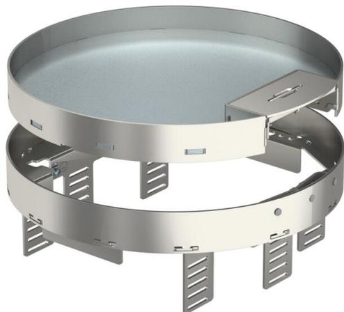
Cassette réglable en hauteur et découplée par rapport au plancher de taille nominale R7, avec sortie de cordon, pour le montage d'appareillages dans des planchers nettoyés à sec en intérieur, pour le montage dans des boîtes de tirage UZD350-3 en association avec un couvercle de montage DUG350-3R7 ou dans des boîtes de tirage UGD350-3R7. Le montage s'effectue à l'aide d'équerres de nivellement (à commander séparément) dans le profilé de cadre en aluminium des boîtes de tirage.
