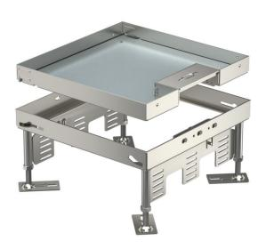
Cassette réglable en hauteur de dimension nominale 9 avec sortie de cordon destinée au montage d'appareillages dans des planchers nettoyés à sec. Cassette réglable en hauteur avec sortie de cordon, 3 compartiments. Il est possible d'installer 3 plaques de recouvrement APMT5. Pour le montage de 3 supports universels UT4 pour 9 appareillages d'installation individuelle avec anneau porteur/étrier porteur ou 6 appareils Modul 45.
