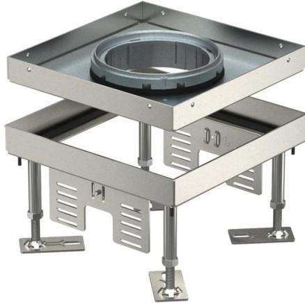
Cassette pour charges lourdes réglable en hauteur avec tube avec une classe de charge 1 à 10 kN, à 2 compartiments. Il est possible d'installer 2 plaques de recouvrement APMT2. Pour le montage de 2 supports universels UT3 pour 4 appareillages d'installation individuelle avec anneau porteur/étrier porteur ou 6 appareils Modul 45.
