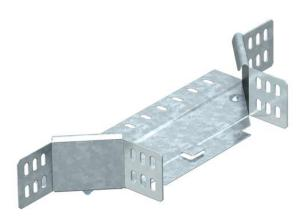
Dérivation à monter pour montage horizontal et vertical. Pour tous les types de chemins de câbles d'une hauteur latérale de 60 mm. La pièce préformée est livrée en pièces non assemblées. Avec matériel de fixation en quantités nécessaires.
