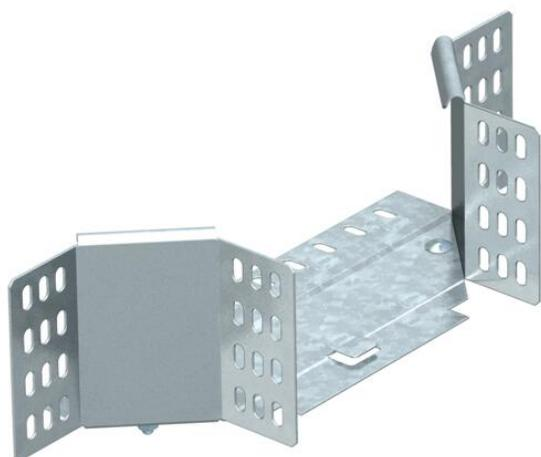
Dérivation à monter pour montage horizontal et vertical. Pour tous les types de chemins de câbles d'une hauteur latérale de 110 mm. La pièce préformée est livrée en pièces non assemblées. Avec matériel de fixation en quantités nécessaires.
