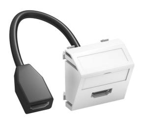
Support multimédia avec une prise de raccordement HDMI, sortie de câbles oblique, avec champ d'inscription, raccord HDMI court en version femelle-femelle. Plaque-support avec fixation à encliqueter, adaptée au montage horizontal et vertical dans l'environnement du système.
