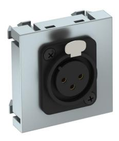
Support multimédia avec une prise de raccordement XLR, sortie de câbles droite, sans champ d'inscription, prise XLR 3 pôles avec raccord à vis. Plaque-support avec fixation à encliqueter, adaptée au montage horizontal et vertical dans l'environnement du système.
