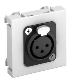
Support multimédia avec une prise de raccordement XLR, sortie de câbles droite, sans champ d'inscription, prise XLR à 3 pôles avec raccord soudé. Plaque-support avec fixation à encliqueter, adaptée au montage horizontal et vertical dans l'environnement du système.
