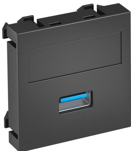
Support multimédia avec une prise de raccordement USB 3.0, sortie de câbles droite, avec champ d'inscription, prise USB 3.0 type A avec raccord à vis. Plaque-support avec fixation à encliqueter, adaptée au montage horizontal et vertical dans l'environnement du système.
