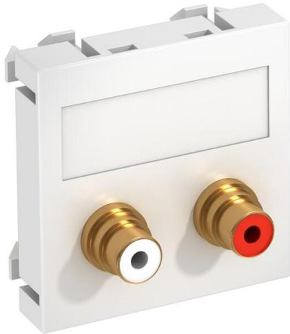
Support multimédia avec deux prises de raccordement Cinch pour audio R/L, sortie de câbles droite, avec champ d'inscription, deux raccordements Cinch (RCA) en version femelle-femelle, code couleur rouge/blanc. Plaque-support avec fixation à encliqueter, adaptée au montage horizontal et vertical dans l'environnement du système.
