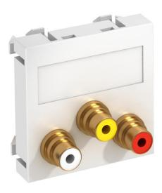
Support multimédia avec trois prises de raccordement Cinch pour audio-vidéo, sortie de câbles droite, avec zone de marquage, trois prises Cinch (RCA) avec raccord soudé, code couleur jaune/rouge/blanc. Plaque-support avec fixation à encliqueter, adaptée au montage horizontal et vertical dans l'environnement du système.
