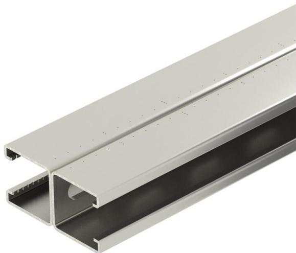
Rail de montage profilé avec perforation continue au fond modèle lourd et ouverture 22 mm. En version double, c.-à-d. que deux rails profilés sont reliés au niveau du sol (soudés).
