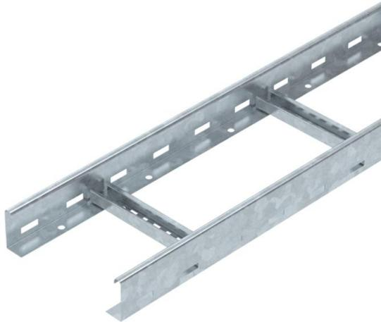
Échelle à câbles d'une hauteur latérale de 60 mm avec barreaux soudés profilés en C ouverts en haut. Longeron latéral enroulé pour le renforcement et la protection des bords. La fixation sur console s'effectue avec des pièces de serrage de type LKS 40. La dimension de la fente de l'échelon est de 17 mm, le clip de support correspondant est de type 2056U. Atténuation magnétique sans couvercle 10 dB, avec couvercle 15 dB.
