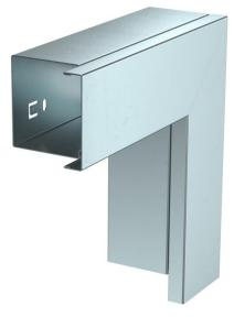
Angle plat avec couvercle pour un changement de direction des goulottes LKM. Liaison équipotentielle assurée sans autre accessoire, entre le socle et le couvercle.
